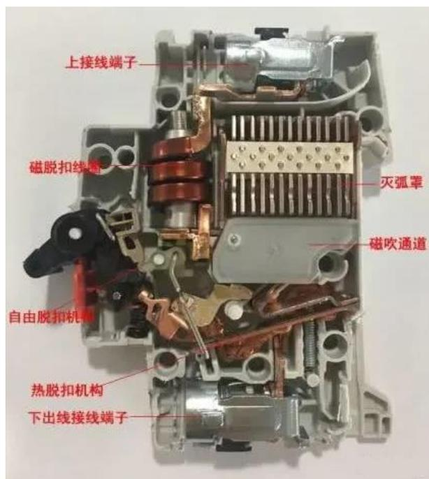
图 1 微型断路器内部结构
